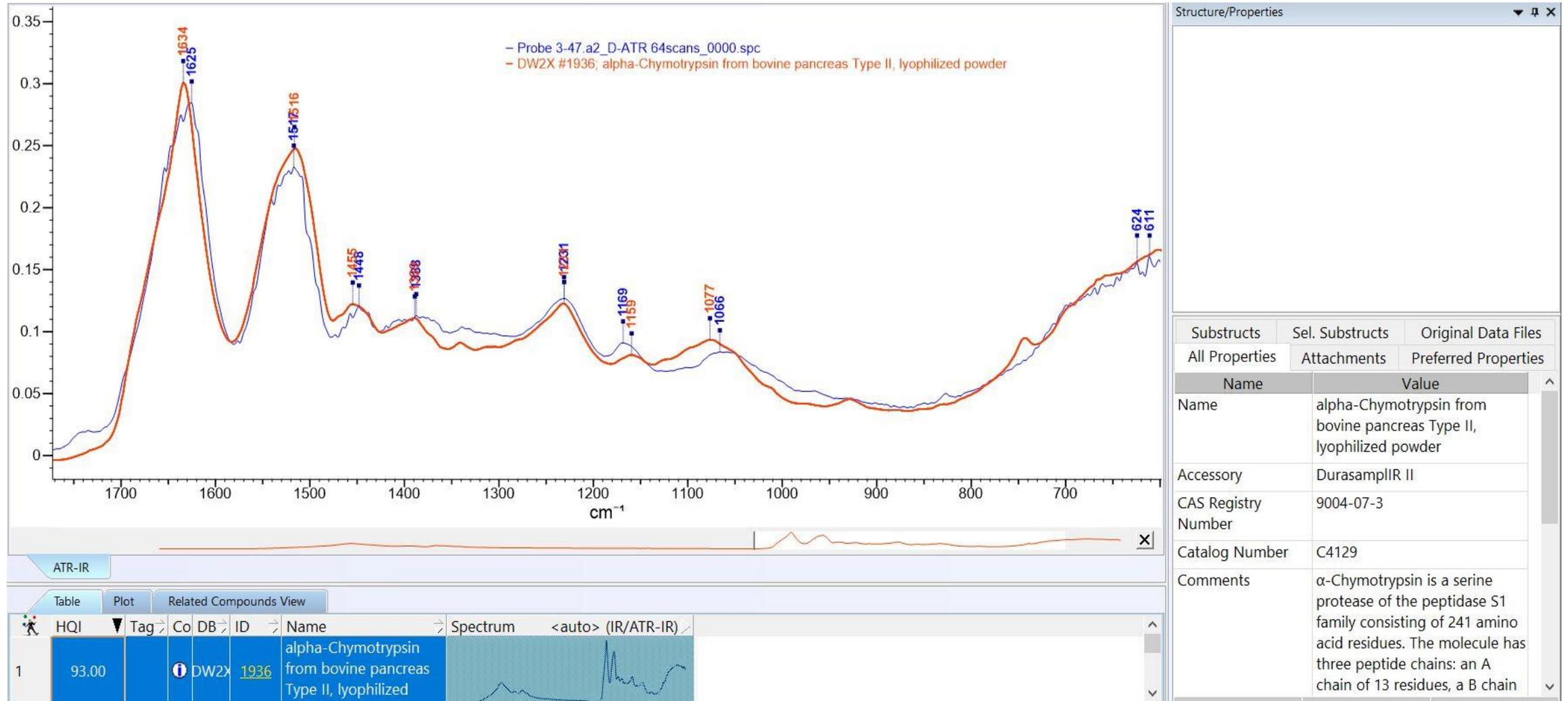
**Abb. 7:** Probe 3-47 (blaue Linie), siehe **Abb. 6**; Spektralbereich 1750-600cm<sup>-1</sup>, überlagert mit IR-DB-Hit (93% Übereinstimmung) α-Chymotrypsin
