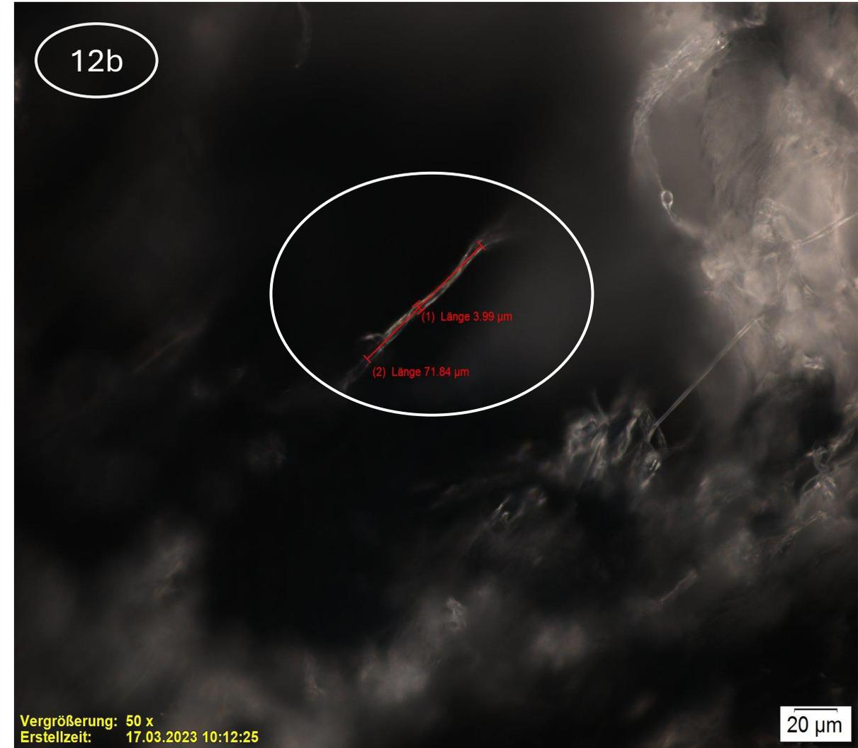
**Abb. 12a-b:** Probe 3-47 eingebettet in Paraffin, Mikrotomschnitte, Lichtmikroskop mit 500-facher (50x10) Vergrößerung unter polarisiertem Licht. Bild 12a zeigt einzelne Faser, mit Habitus **nanoskalig und innen hohl**; 12b mit Durchmesser (als "Länge" angegeben) von ca. 3.99 µm und ca. Länge 71.84 µm (nur sichtbarer Teil aus Querschnitt)
